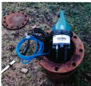
Sonde piézométrique installée au forage « l'Infernet » à St Guilhem-le-Désert.
